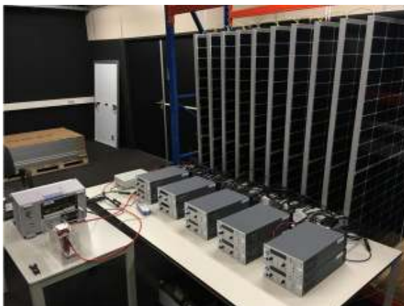
Figuur 1. TNO's laboratorium test faciliteit voor het test van vlamboog detectie volgens de UL1699B standaard.
